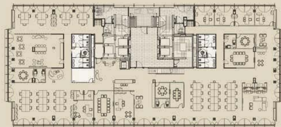
Esempio di layout distributivo degli spazi in un piano tipo. Sample layout of a typical floor. L'affollamento massimo previsto per piano tipo è di 99 persone. The maximum occupancy envisaged for the typical floor is 99 people.
